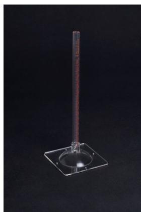
写真2 現場透水量試験器（水平面用）
