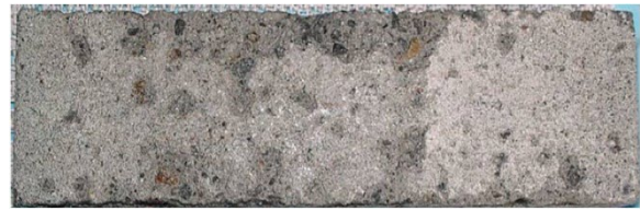
写真2 反応型 SG (900 サイクル)
