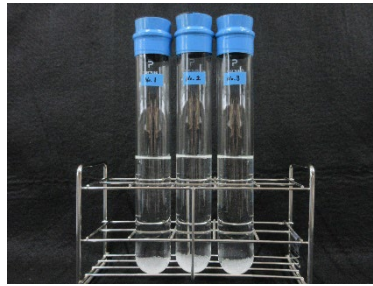
写真 10 乾燥固形分の溶解状況【反応型】 (初期状態)
