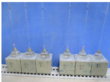
写真 20 透水量試験状況
