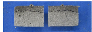
写真 38 水の浸透深さ【反応型】
