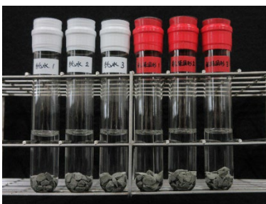
写真 12 反応性確認状況【反応型】 (初期状態)
