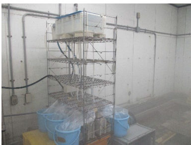
写真 34 ひび割れ透水性試験状況
