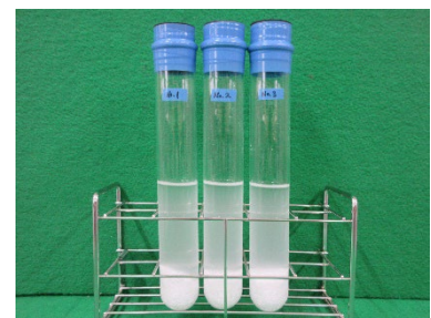
写真 8 乾燥固形分の溶解状況【固化型】 (72時間経過後)
