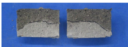
写真3 水の浸透状況（無塗布）
