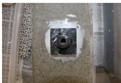
写真 18 治具の接着状況（接着剤）-2
