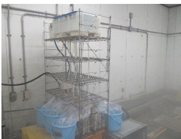
写真7 ひび割れ透水性試験状況-1
