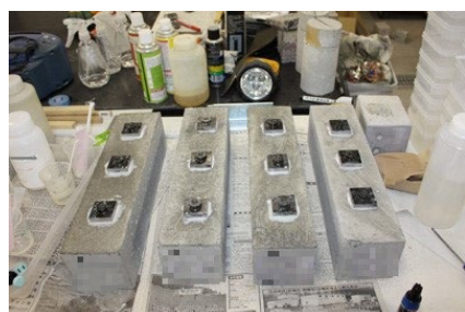
写真 17 治具の接着状況（接着剤）-1
