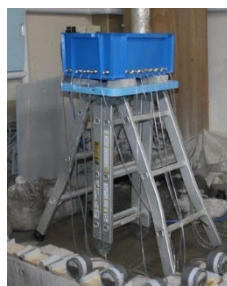
写真8 ひび割れ透水性試験状況-2
