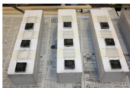
写真14 治具の接着状況（塗装材）-1
