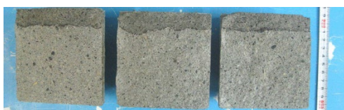
写真5 水の浸透状況（無塗布）
