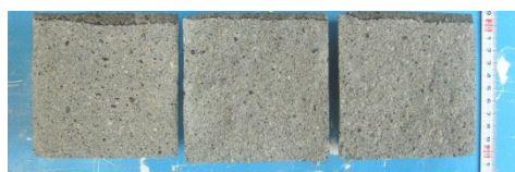
写真6 水の浸透状況（固化型）
