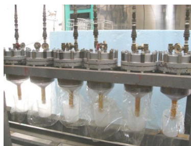
写真2 加圧透水性試験状況-2
