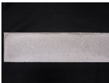
写真1 PCM 施工前試験体（無塗布）
