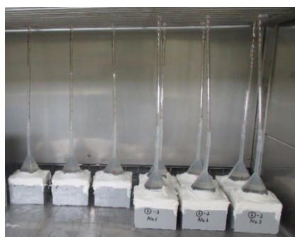
写真10 B社PCM透水量試験状況
