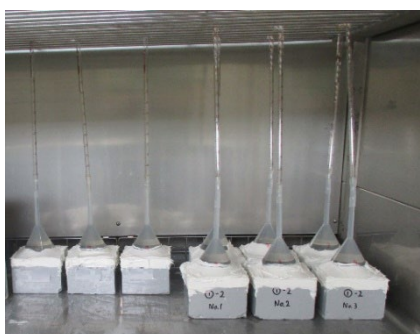
写真9 A社PCM透水量試験状況
