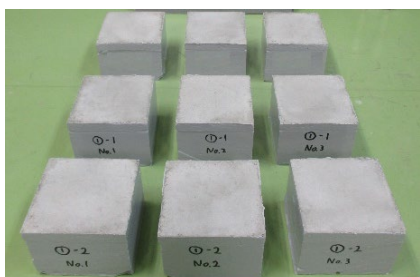
写真3 A社PCM打設後
