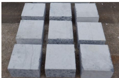
写真1 A社PCM打設前基板
