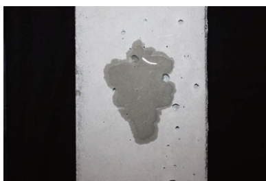
写真4 濡らした試験体（無塗布）
