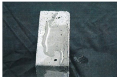
写真 13 濡らした試験体（無塗布）
