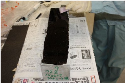
写真1 速乾接着剤塗布状況
