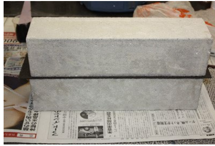
写真2 防水シート貼付後、試験体を載せ均一に貼付けている状況
