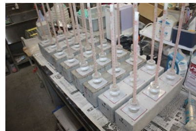
写真3 透水量試験状況
