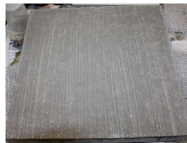
写真5 表面含浸材塗布後の基板
