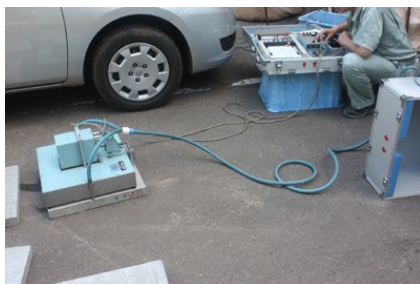
写真6 すべり抵抗試験状況-1
