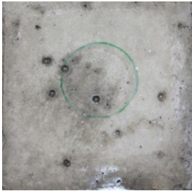
写真4 試験器貼付箇所 (けい酸塩系表面含浸材のみ塗布試験体)
