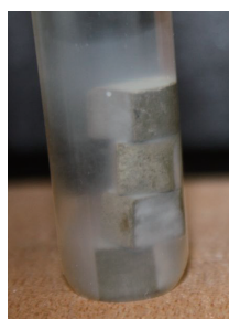
セメントペースト片と反応して C-S-Hゲルを生成している
