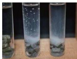
セメントペースト片と反応して C-S-Hゲルを生成している
