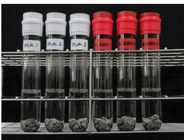
写真 7 反応性確認状況【反応型】
