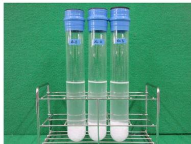
写真2 乾燥固形分の溶解状況【固化型】
