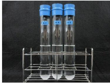
写真 5 乾燥固形分の溶解状況【反応型】
