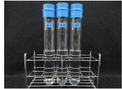
写真 6 乾燥固形分の溶解状況【反応型】
