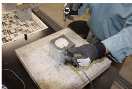
写真2 ガスバーナーでの加熱状況-2
