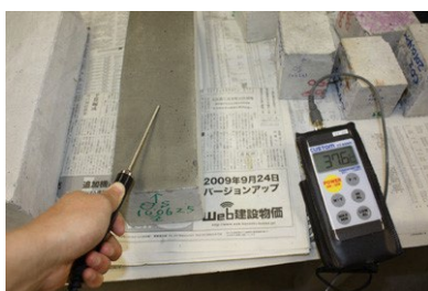
写真4 散水養生後温度測定状況
