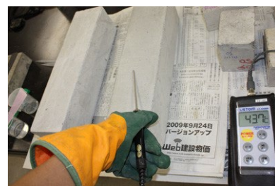
写真3 散水養生前温度測定状況
