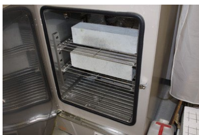
写真1 恒温槽への設置状況
