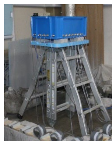
写真8 ひび割れ透水性試験状況-2
