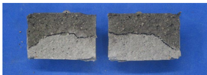
写真3 水の浸透状況（無塗布）
