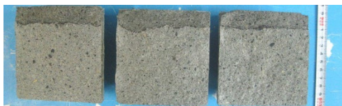
写真5 水の浸透状況（無塗布）
