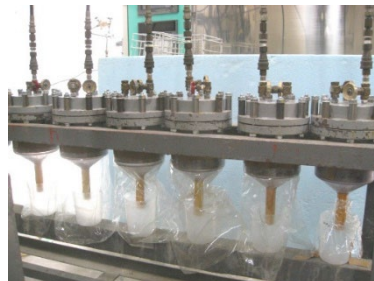
写真2 加圧透水性試験状況-2
