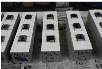
写真2 治具周囲への切り込み
