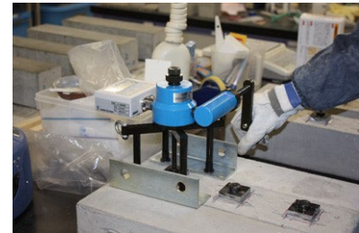
写真6 付着強さ試験状況
