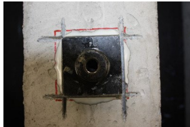
写真5 治具周囲への切り込み (拡大)
