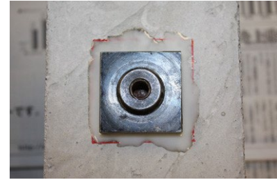
写真3 治具の接着状況 (拡大)
