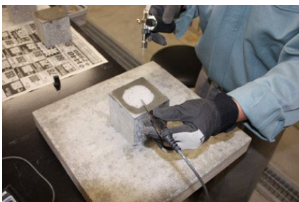
写真 1 ガスバーナーでの加熱状況（塗布後 1 時間）
