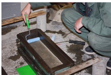
写真2 打継ぎ面への塗布状況
