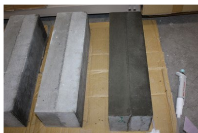
写真4 外周面への塗布状況
