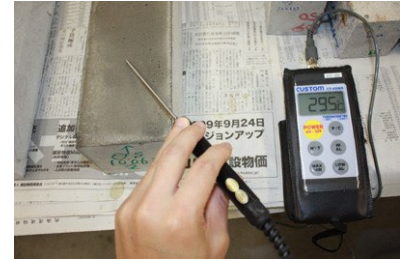
写真5 含浸材塗布後温度 (29.5 °C)
