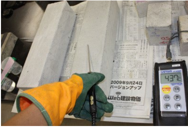
写真3 散水養生前温度 (43.7 °C)
