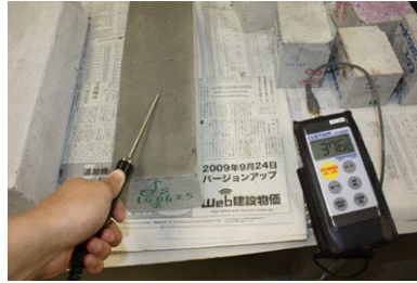
写真4 散水養生後温度 (37.6 °C)
