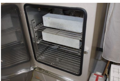
写真1 恒温槽への設置状況
