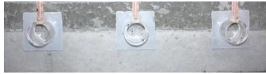
写真2 打継ぎ試験体での透水量試験状況（拡大）
