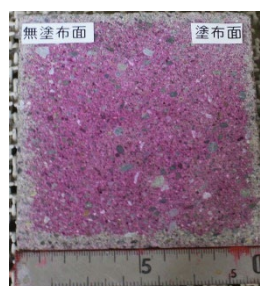
写真4 試験体 C 中性化深さ
