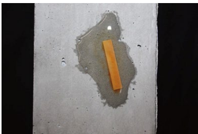
写真5 pH 試験紙接触状況（けい酸塩系）
