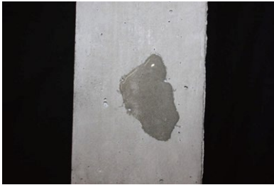
写真3 濡らした試験体（けい酸塩系）
