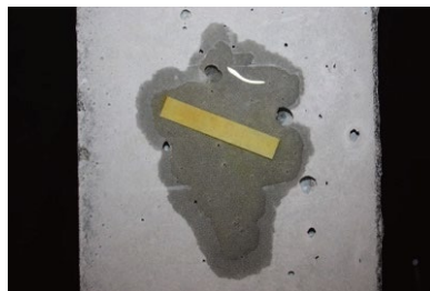
写真6 pH 試験紙接触状況（無塗布）
